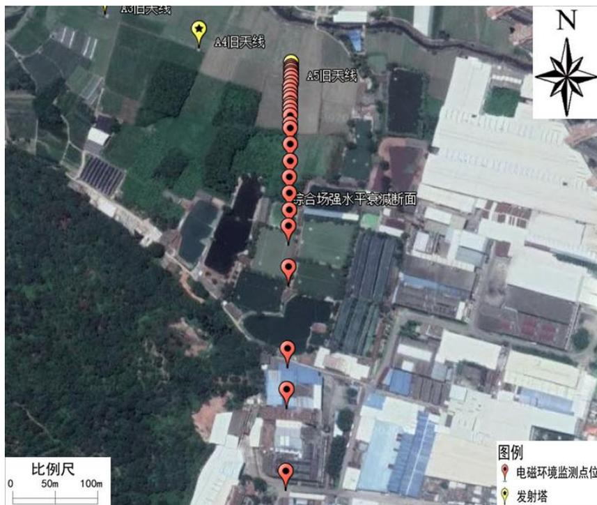
图6.1-9 旧501台（漳州）发射塔不同水平距离监测布点示意图
