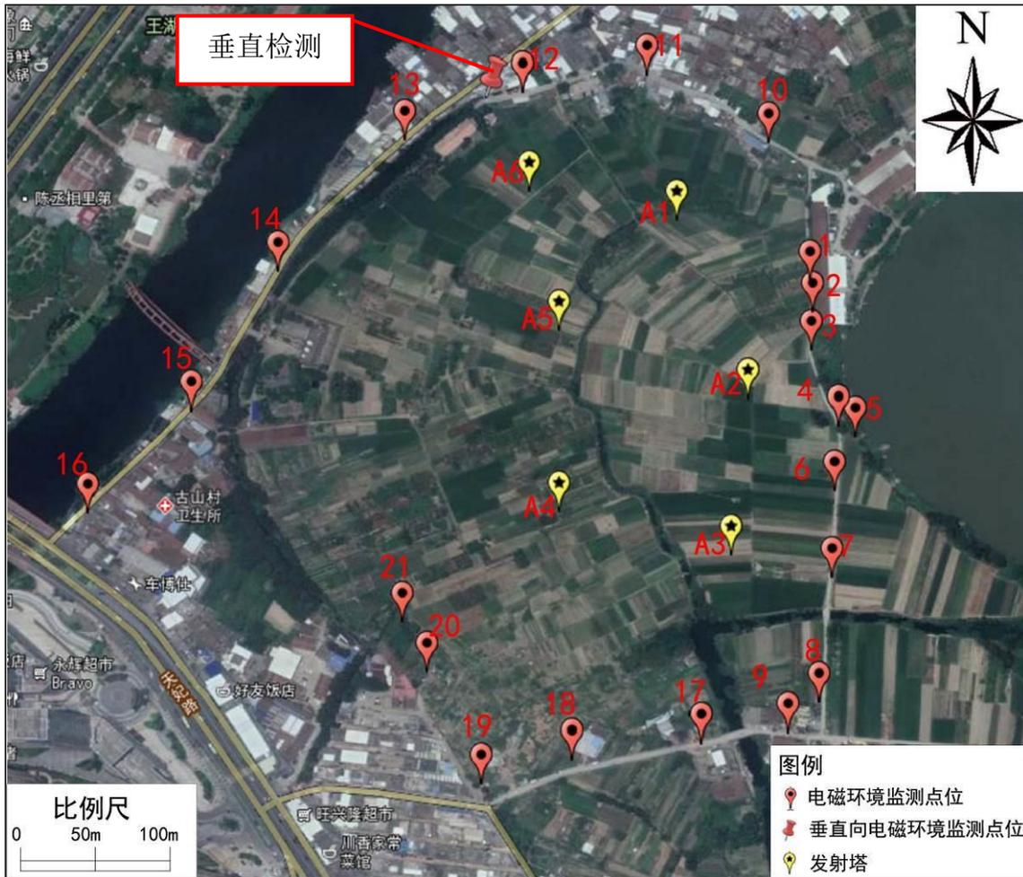
图6.1-11 现有301台（莆田）电磁辐射环境现状监测布点示意图
