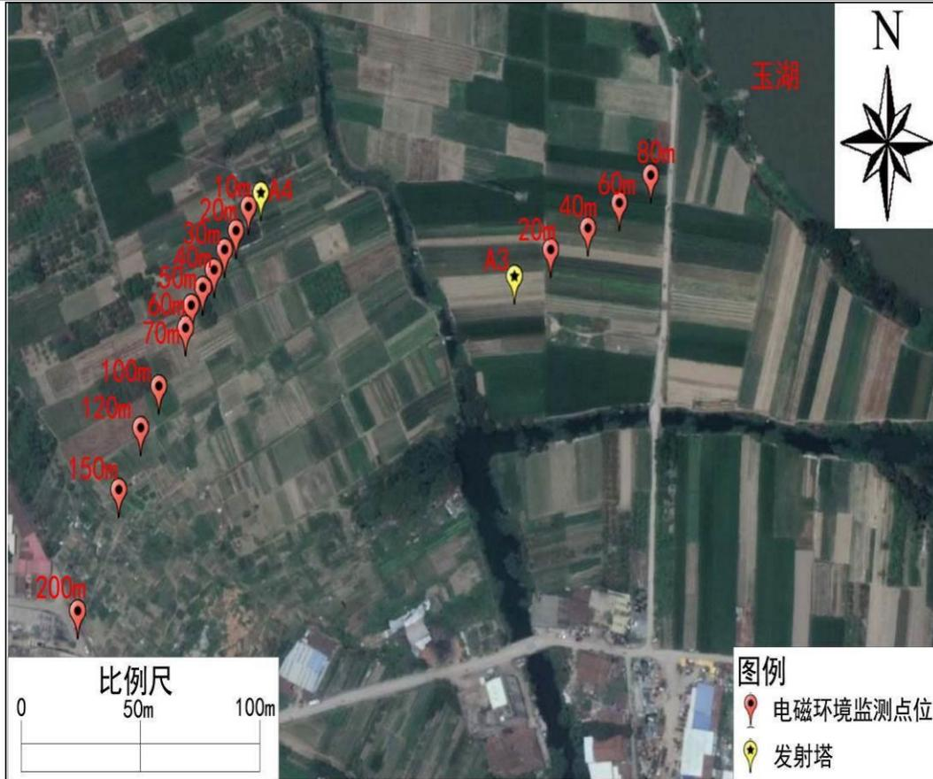
图6.1-7 301台（莆田）A3、A4发射塔不同水平距离监测布点示意图
